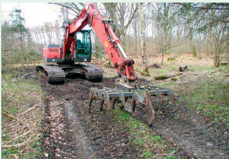
Foto 2. Bæltegraver med risskubber, fremstillet af den lokale smed.
